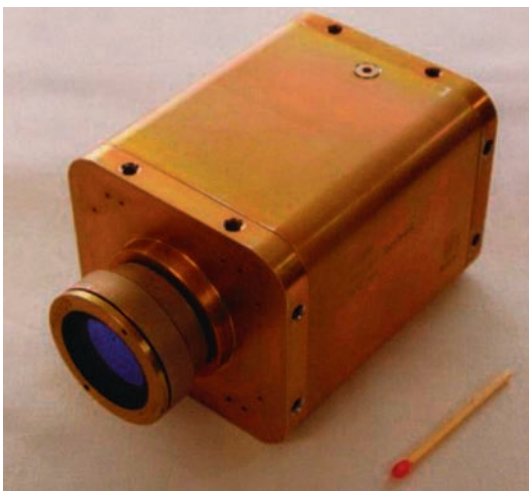
Voorbeeld van een VMC camera ontwikkeld voor ruimtevaart-toepassingen (XMM – CLUSTER II – MARS-EXPRESS).
