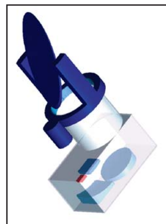
3D concept van het OSDT instrument aangevuld met een extra scanning spiegel om de zeer snelle debris deeltjes (tot 15 km/s) te kunnen volgen.
