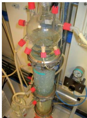
Bioreactor met microorganismen op dragermateriaal voor de behandeling van afvalwater
