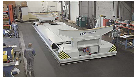
AeroGo leverde een 16-meter lange AGV op luchtkussens voor het dragen en bewegen van vliegtuigfuselages tot 40 ton tussen de verschillende werkstations.
