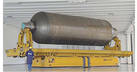
Een 130-Ton Aero-Pallet™ Transporteur van AeroGo verplaatst mals van brandstoftanks voor de Ariane raket en dit tussen de verschillende werkstations. De transporteur is uittrekbaar van 8,4 tot 12 meter.
